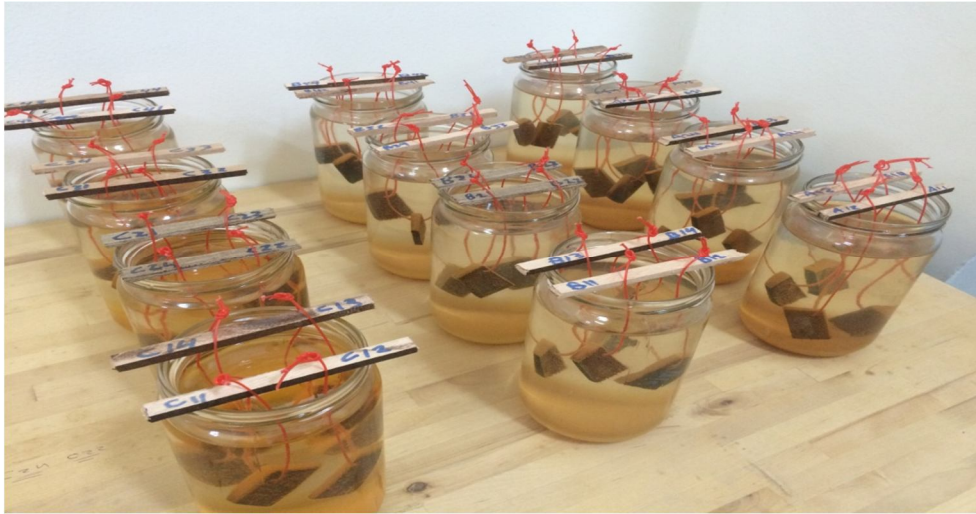
الشكل (2) يوضح العينات مغمورة في أوساط التآكل المختلفة
